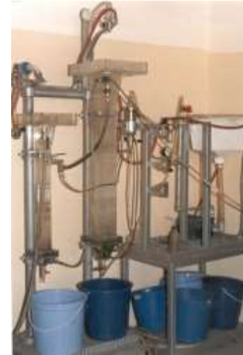
Kolon Flotasyon Ünitesi
