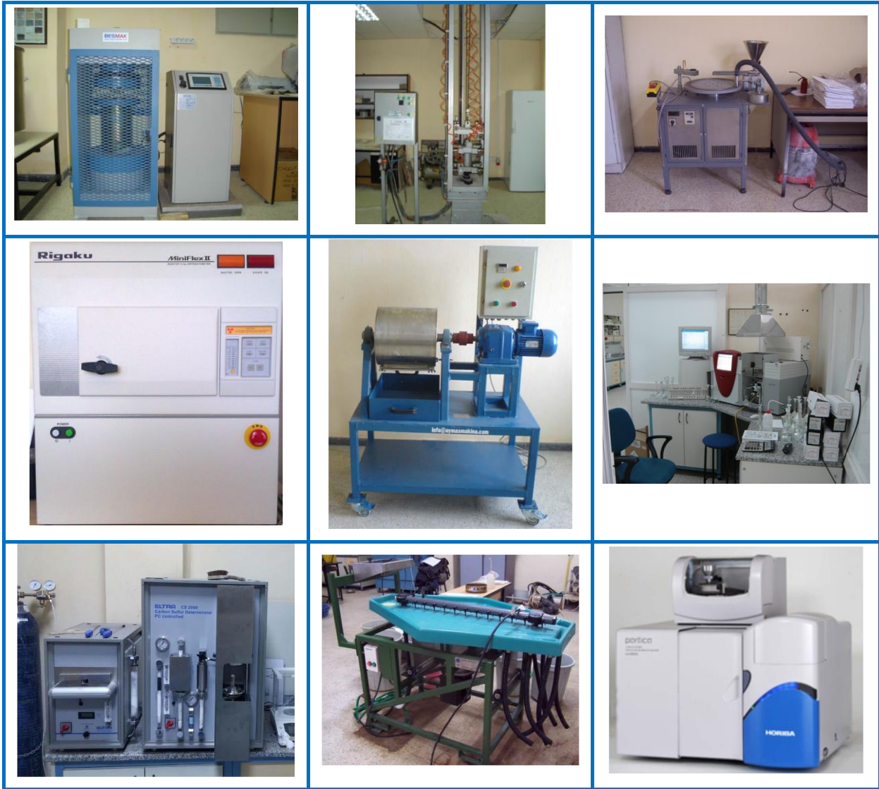
Şekil 7.2 Dokuz Eylül Üniversitesi Maden Mühendisliği Bölüm Laboratuvarlarında Bulunan Cihazlardan Örnekler (soldan sağa birinci sıra: Hidrolik pres, Darbe dayanımı test cihazı, Aşınma değeri test cihazı; ikinci sıra: XRD (X Işını Difraksiyon Cihazı), Bond değirmeni, Atomik absorpsiyon spektrofotometresi; üçüncü sıra: Karbon kükürt tayin cihazı, Gemeni sallantılı masası, Partikül Boyut Analizörü)
